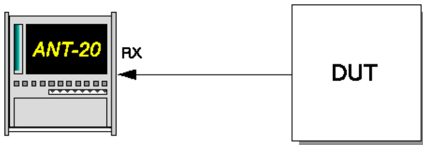
Bild A-15 Meßaufbau für Phasehit-Messungen
